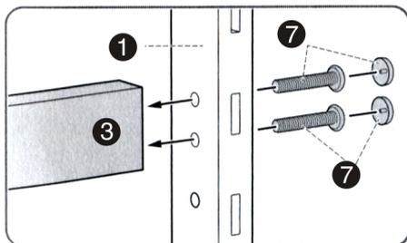
Скрепить винтами **7** стойки стеллажа **1** и горизонтальные штанги **3** при помощи торцового ключа **11**, затем установить колпачки **7**.
