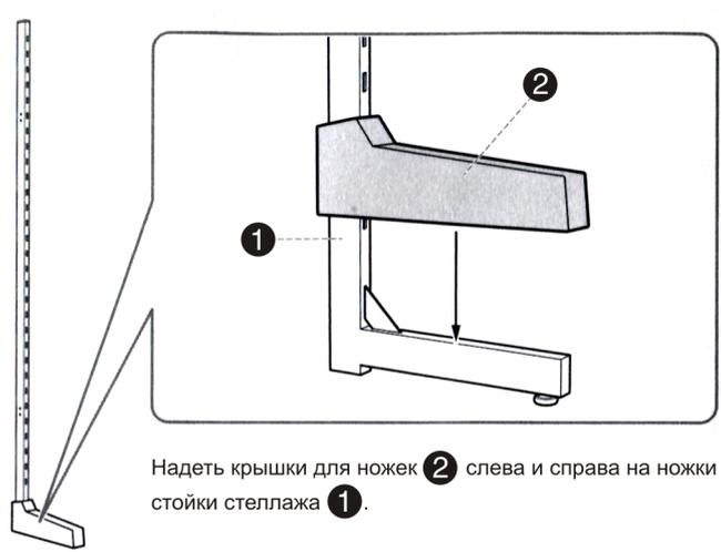
Надеть крышки для ножек **2** слева и справа на ножки стойки стеллажа **1**.
